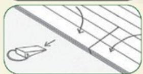
**7.-8.** Dřevěným špalíkem doklepejte desku na své místo, odstraňte klínka a lehce přitlačte. Těsného spoje doclíte jemným poklepáním špalíkem. Tímto způsobem pokračujte v montáži.
