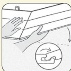
2. Přitlačte další podlahovou desku k první pod úhlem  $20^\circ$  a položte ji. Tako pokračujte po celé délce první řady. Poslední desku přířízněte s ohledem na ponechání dilatační spáry. Před instalací odstraňte případné nečistoty a odřezky. Nečistoty mohou zapříčinit jisté napětí a punutí v podlaze.
