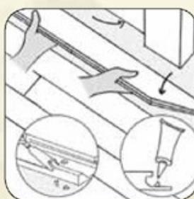
**13.** V jistých případech – např. pokud má být deska umístěna pod zárubně nebo nízké radiátory – odstraňte okraj zámku a naneste trochu lepidla tak, jak je znázorněno na obrázku. Dílec horizontálně spojíte poklepáním dřevěným špalíkem. Výsledkem je lepený spoj. Nakonec odstraňte distanční klínky a namontujte krycí prvky a soklové lišty.
