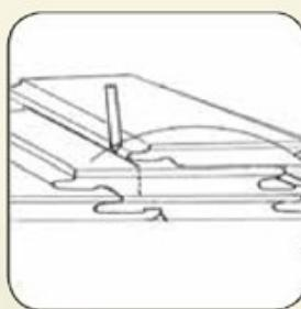
**12.** Poslední řada parket by měla být přírezána na správnou šířku. Měla by být zachována dilatační spára: žádný dílec se nesmí dotýkat stěny nebo jiné pevné stavební konstrukce. Ve dveřích doporučujeme podlahu přerušit. Pokud mezi místnostmi není dveřní práh, použijte k zakrytí mezery přechodový profil.
