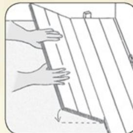
4. Usaďte první desku druhé řady pod  $20^\circ$  úhlem do řady první. Myslete na to, že hrany obou desek by se měly dotýkat po celé délce – můžete si pomocí dřevěným špalíkem. Přitlačte k zemi.
