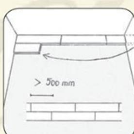
3. Začněte druhou řadu dílem, který vám zbyl po odřezání na konci první řady. Mějte na paměti, že přesah čel dílců mezi jednotlivými řadami musí být minimálně 500 mm.
