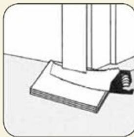
**11.** Zárubné dveří mohou být podřezány. Použijte zbytku podlahy a poté vsuňte podlahového dílce pod již podřezané zárubně.
