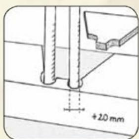
**10.** V případě procházejících pevných částí, trubek topení apod. je nutné pamatovat na zachování dilatační mezery. Průměr otvoru v podlaze by měl být minimálně o 20 mm větší než je průměr trubky. Vyřezaný zbytek přilepte zpět a otvory zakryjte rozetami.
